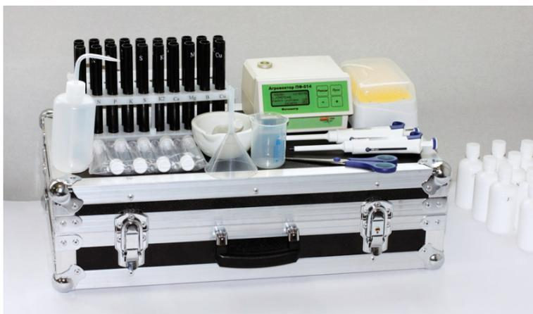
*Рис.* Портативная лаборатория «Агровектор»
