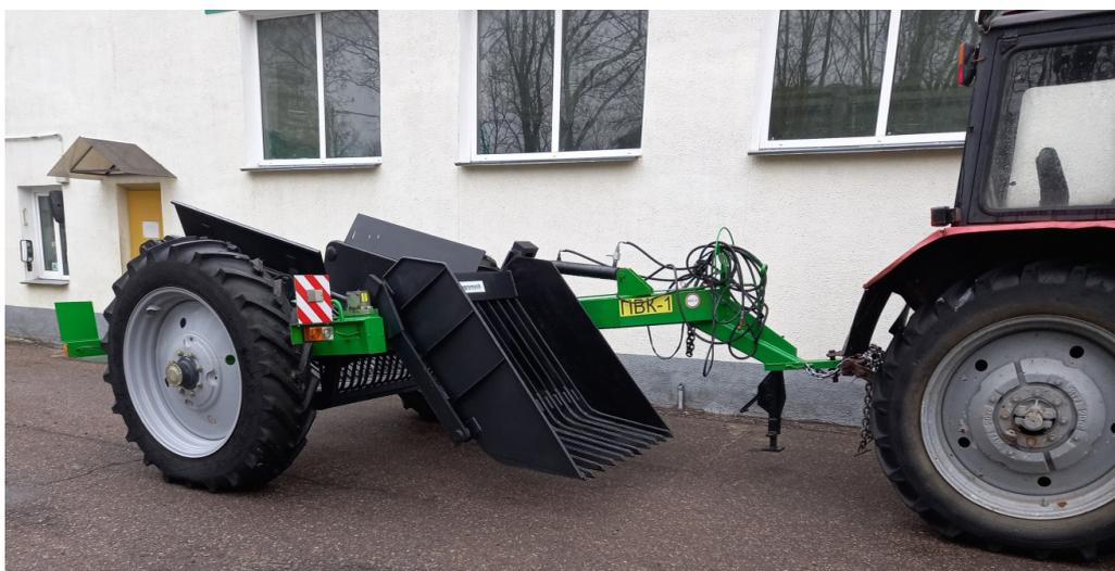
**Описание импортзамещающей продукции:** подборщик предназначен для сбора поверхностных и погруженных до 0,1 м в почву камней размером от 30 до 70 см на полях, свободных от сельскохозяйственных культур и транспортировки их на край поля.
