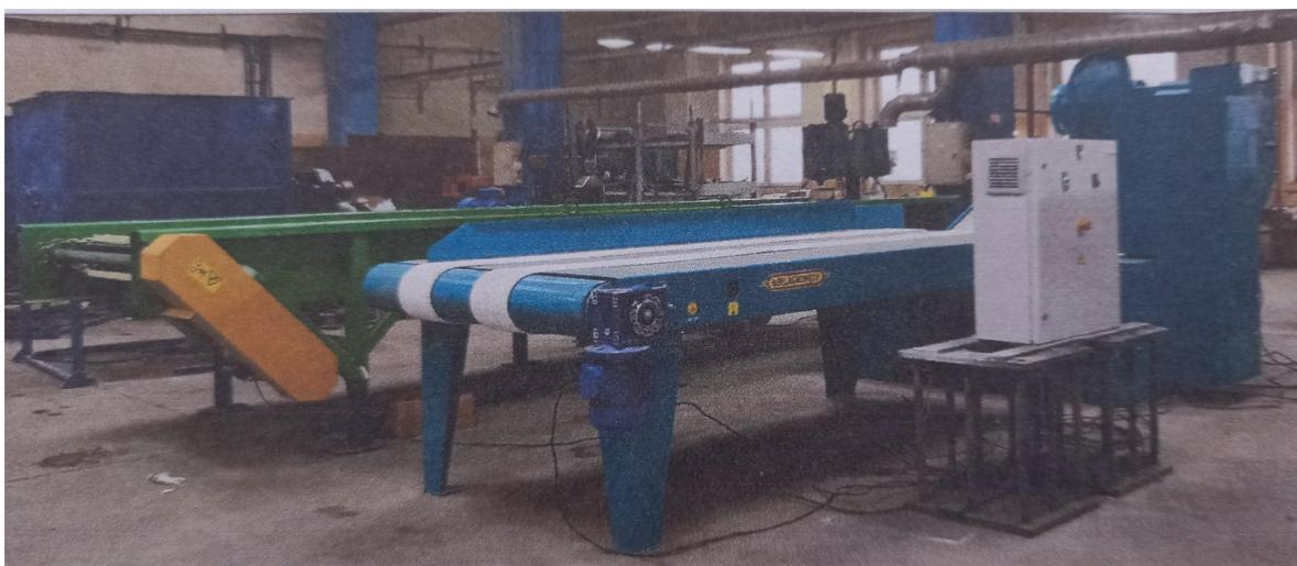
**Описание импортозамещающей продукции:** линия предназначена для аккумуляции партии рулонов тресты на определенное время работы, механизированной их размотки с отбором прокладочного шпагата и передачи ленты тресты в последующую переработку.
