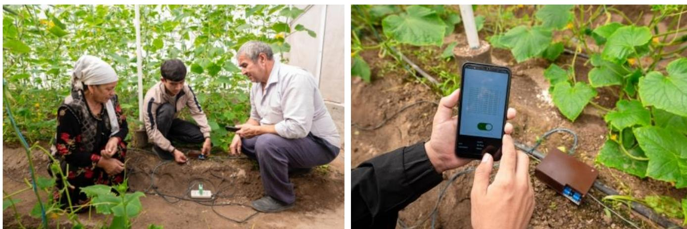
"Умными" датчиками на основе интернета вещей оборудованы теплицы по всей Ферганской долине в Узбекистане. Шаодатхон и ее семья используют датчики, чтобы контролировать температуру и влажность воздуха, освещенность посевов и влажность почвы в теплице. ©ФАО/Даниил Долидзе
