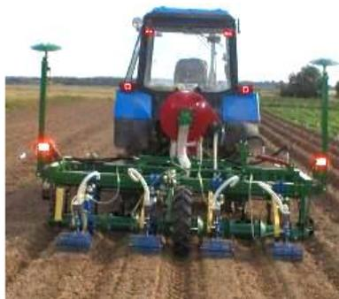
Рис. 1. Агрегат комбинированный посевной АКП-4
