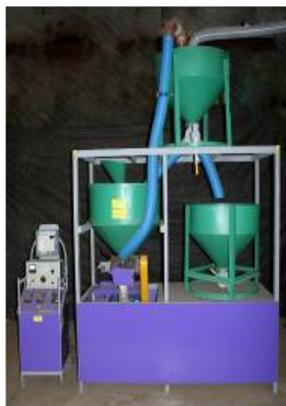
Рис. 4. Установка для обеззараживания семян УОС-1
