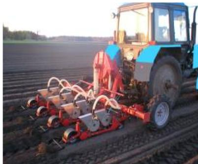
Рис. 2. Сеялка пунктирного высева СПВ-4
