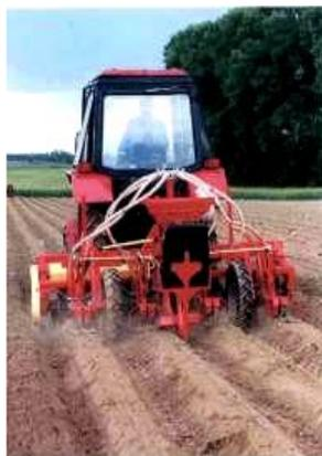
Рис. 3. Агрегат-грядообразователь посевной АГП-2,8
