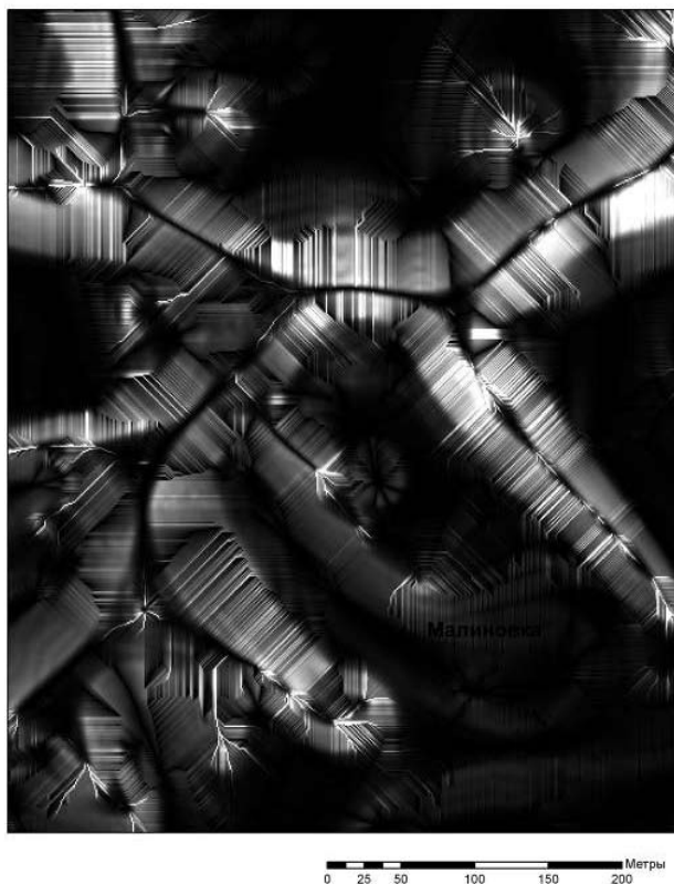
Рис. 4. Отображение результирующего растрового слоя топографического фактора эрозии LS территории тестового полигона «Стоковые площадки» (максимальное значение 378,8, минимальное значение 0, среднее значение 1,68, среднее квадратическое отклонение 5,03)
