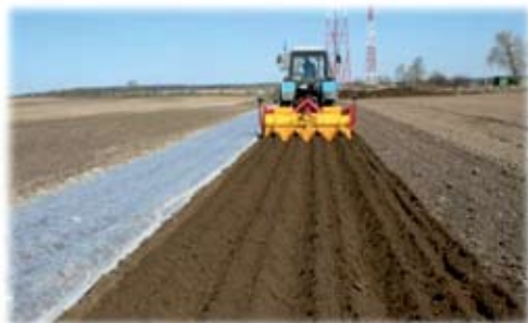
Рис. 1. Гряды, сформированные активными рабочими органами АПК-2,8
