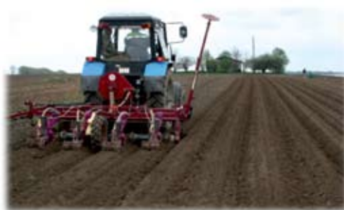
Рис. 2. Гряды, сформированные пассивными рабочими органами АПК-4
